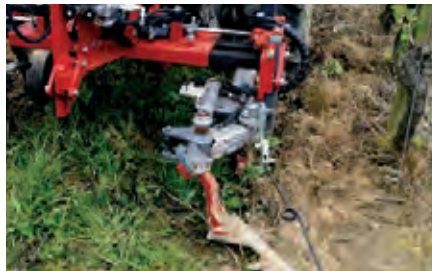
Pour gagner en sensibilité et réactivité des outils, certains constructeurs proposent des palpeurs à commande par électrodistributeur et une sécurité hydraulique.
