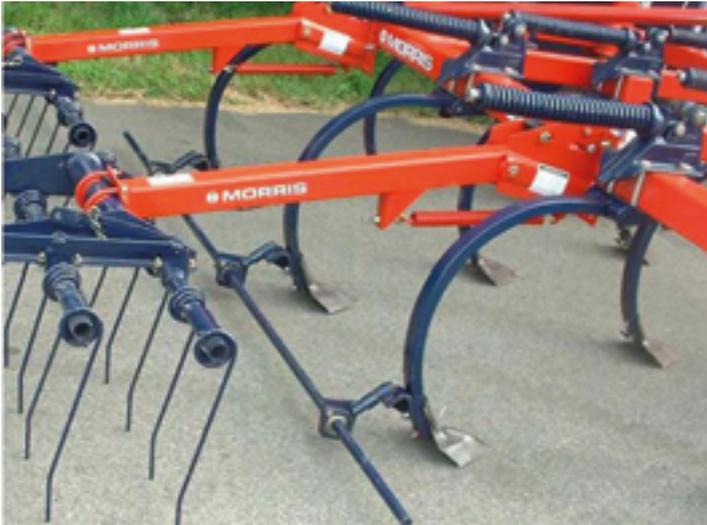
Barre nivelleuse et désherbeuse sur chisel (MORRIS )
